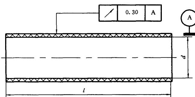
注: 径向圆跳动公差值 0.30 mm 包括面纸接缝处的突跳。
